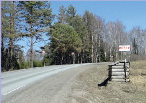
Для тушения автомобиля при возгорании перегретого от движения в гору двигателя. **A**
